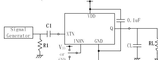
XTN input signal: 1Vp-p, sına wave
