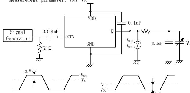
XTN input signal: 1Vp-p, sına wave
